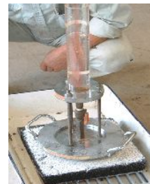
現場透水性試験装置にて試験
